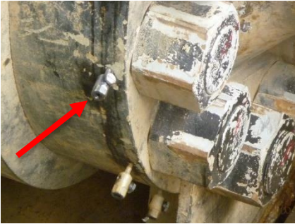
Adaptadores por donde inyectaron el material líquido sellante.
