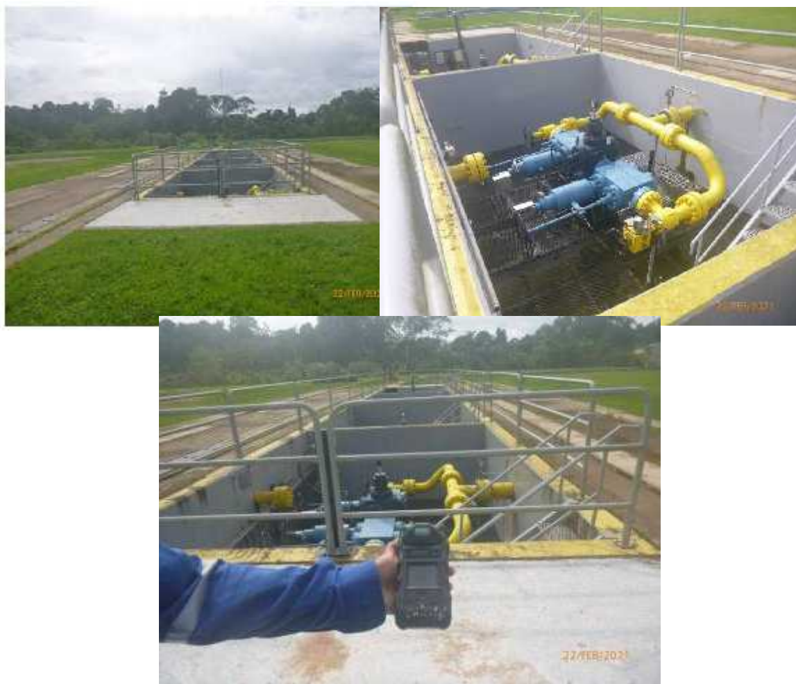
Fotografía 6: Medición del LEL en pozos de la Locación Pagoreni A (Fuente: PPC)
