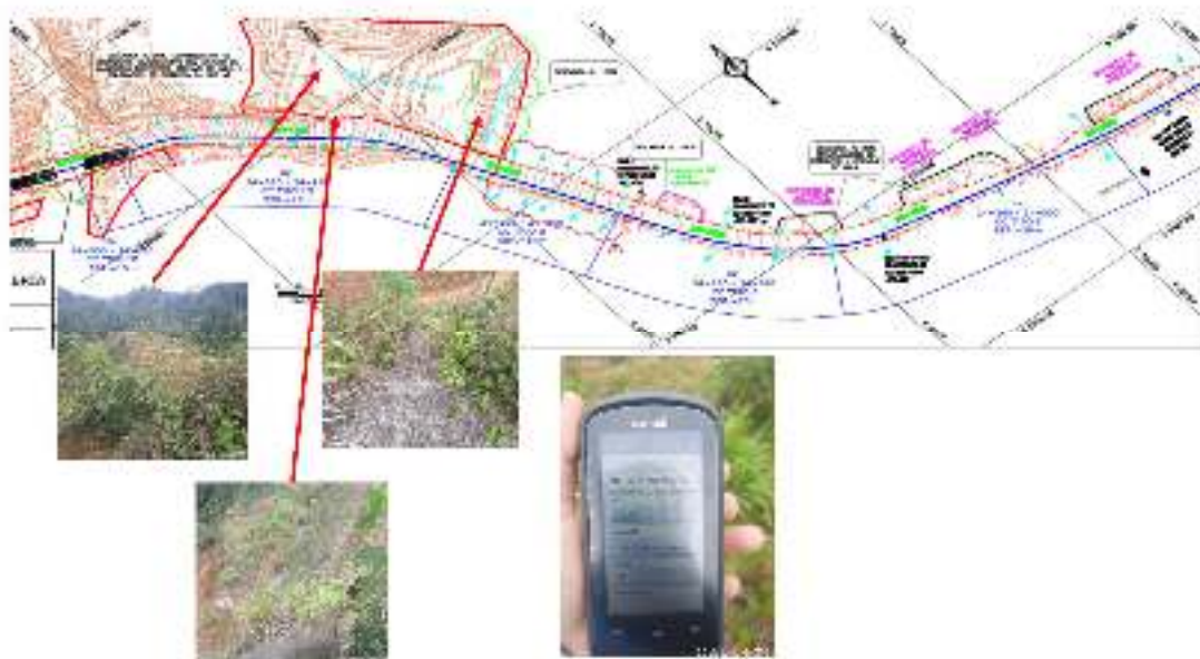
Fotografía 6: Progresivas con evidencias estables de material remanente de tierras, PK 24+ 020 y PK 24+ 180, en Locación DdV ND FL CASH 1 – MLV (Fuente: PPC)
