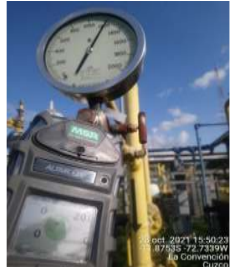
Fotografía 7: Medición del LEL en área de llaves Manifold y medidores de presión en Cashiriari 1 (Fuente: PPC)
