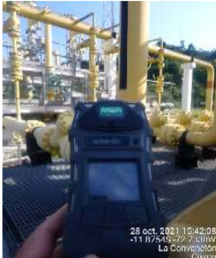
Fotografía 7: Medición del LEL en área de llaves Manifold y medidores de presión en Cashiriari 1 (Fuente: PPC)
