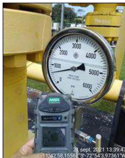
Fotografía 7: Medición del LEL en área de llaves Manifold y medidores de presión en Locación Pagoreni A (Fuente: PPC)
