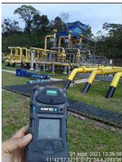
Fotografía 7: Medición del LEL en área de llaves Manifold y medidores de presión en Locación Pagoreni A (Fuente: PPC)
