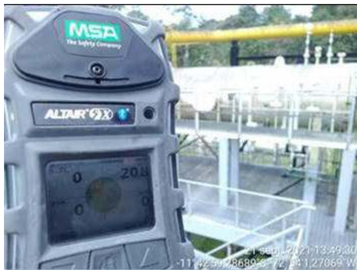
Fotografía 20: Medición del LEL en el área del KOD en Pagoreni A (Fuente: PPC)
